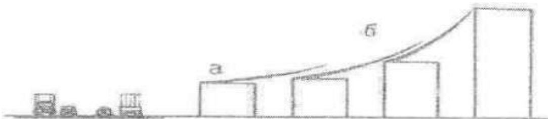
Рис. 4.2. Схема шумозахисного зонування забудови за поверховістю: а – магазини; б – житлові будівлі з наростаючою поверховістю
