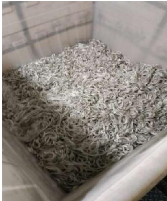
Рис. 2.6. Укладання джгута в ємність
