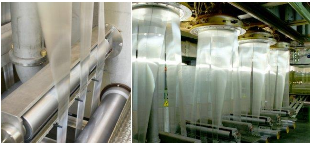
Рис. 2.7. Процес екстракції волокна
