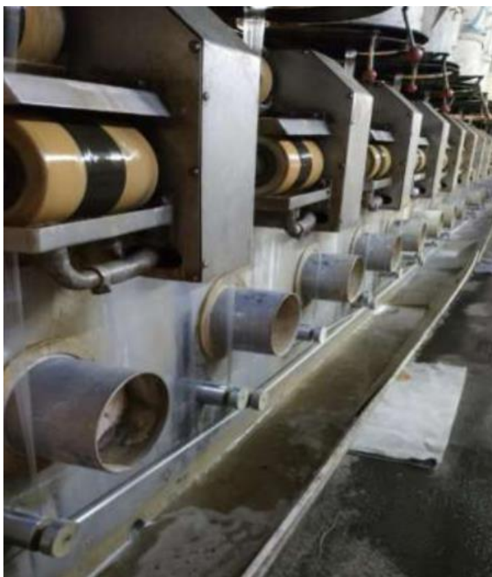
Рис. 2.5. Процес формування джгута із ниточок з первинним обробленням замащувача
