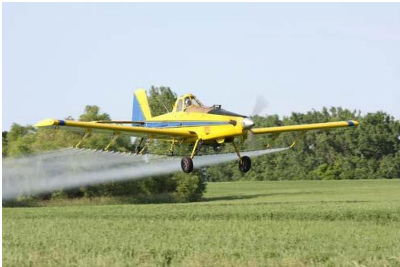
Рис. 3.2.2 Обробка авіаційним методом
