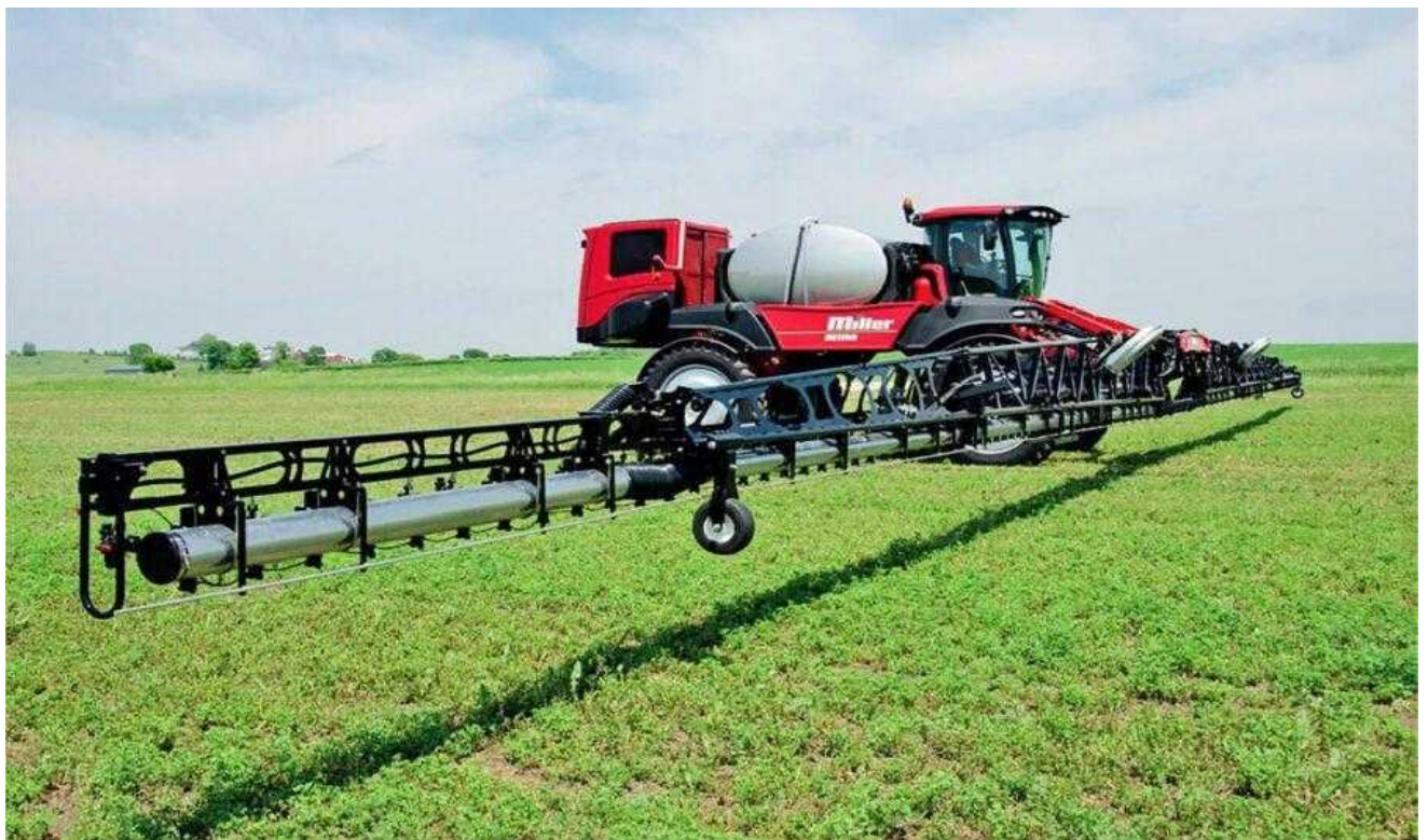
Рис. 3.2.3 Обробка штанговим методом
