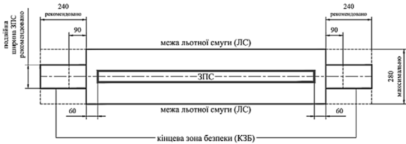
Рисунок 1.2 – Кінцева зона безпеки ЗПС з кодовим номером 3 чи 4
