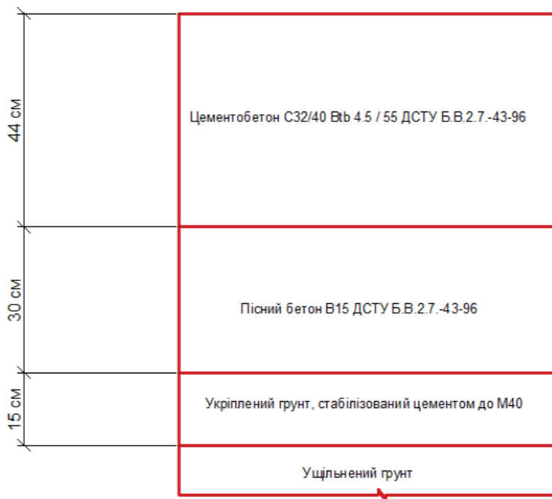
Рисунок В.1 – Запропонована конструкція штучного покриття ЗПС
