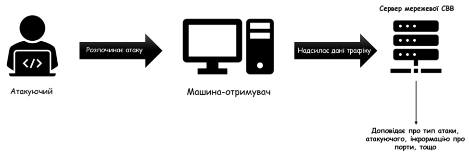
Рис. 1.2. Принцип роботи мережевої СВВ
