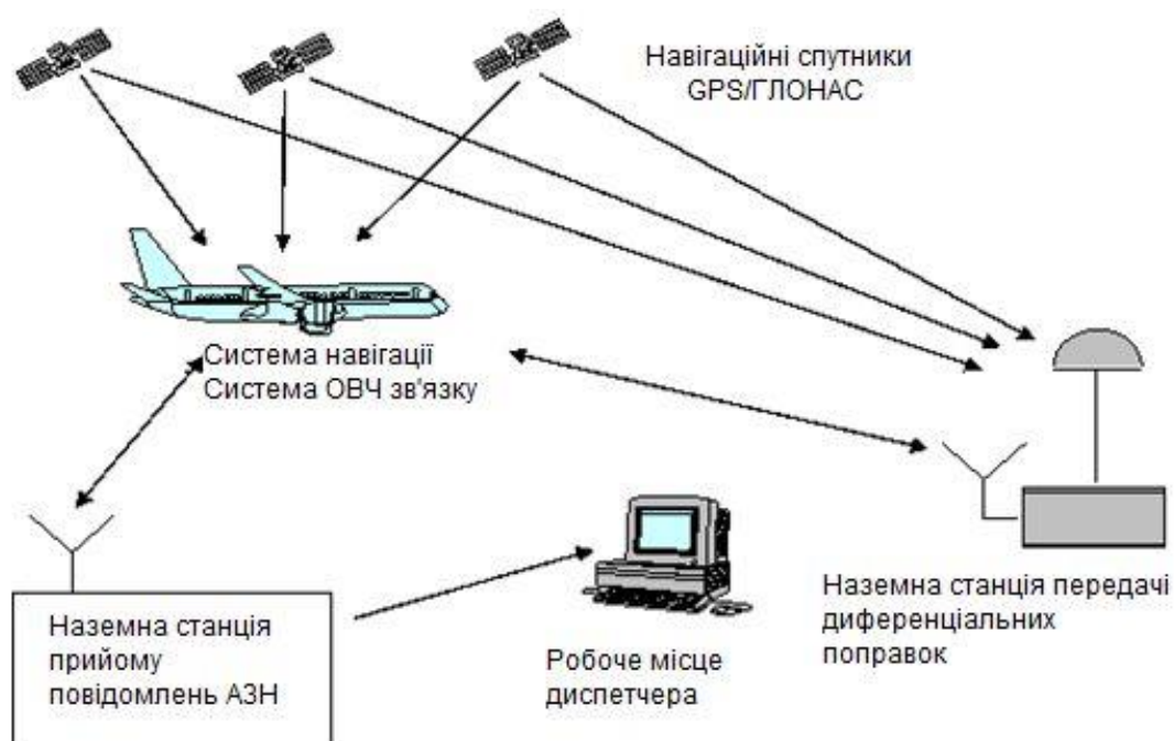
Рис. 1.7. Автоматическое зависимое наблюдение (АЗН) с ДВЧ - каналом
