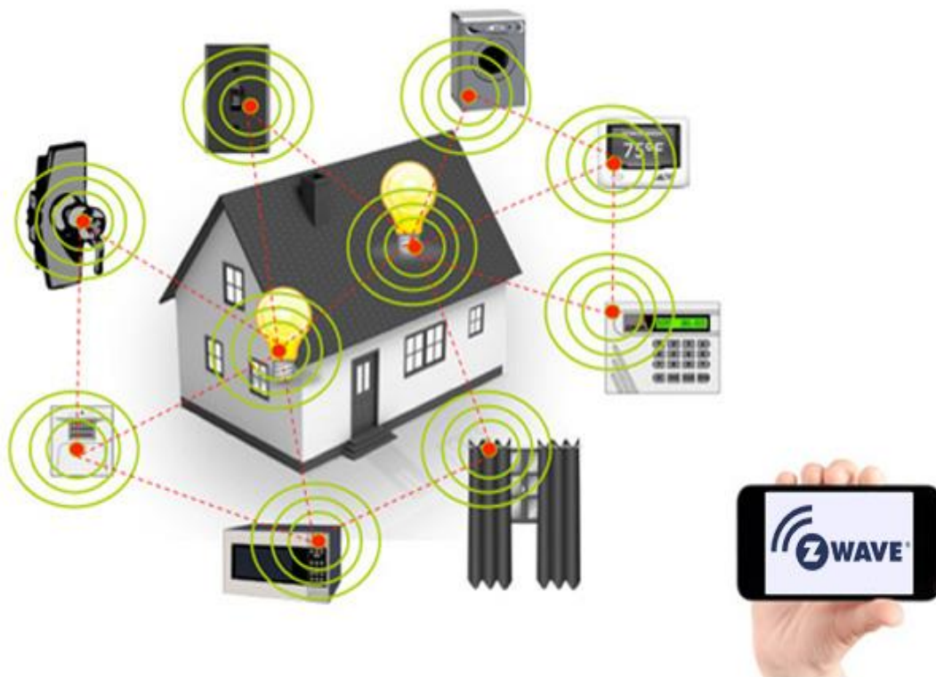
Рис. 2.2. Схема підключення технології Z-wave
