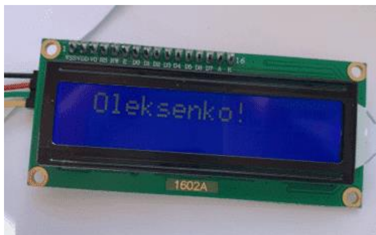
Рис. 4.4. Результат підключення дисплею і завантаження написаного коду на плату
