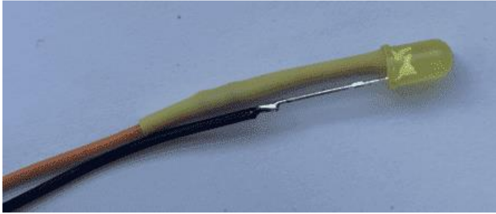
Рис. 4.25. Результат спаювання діоду і резистору
