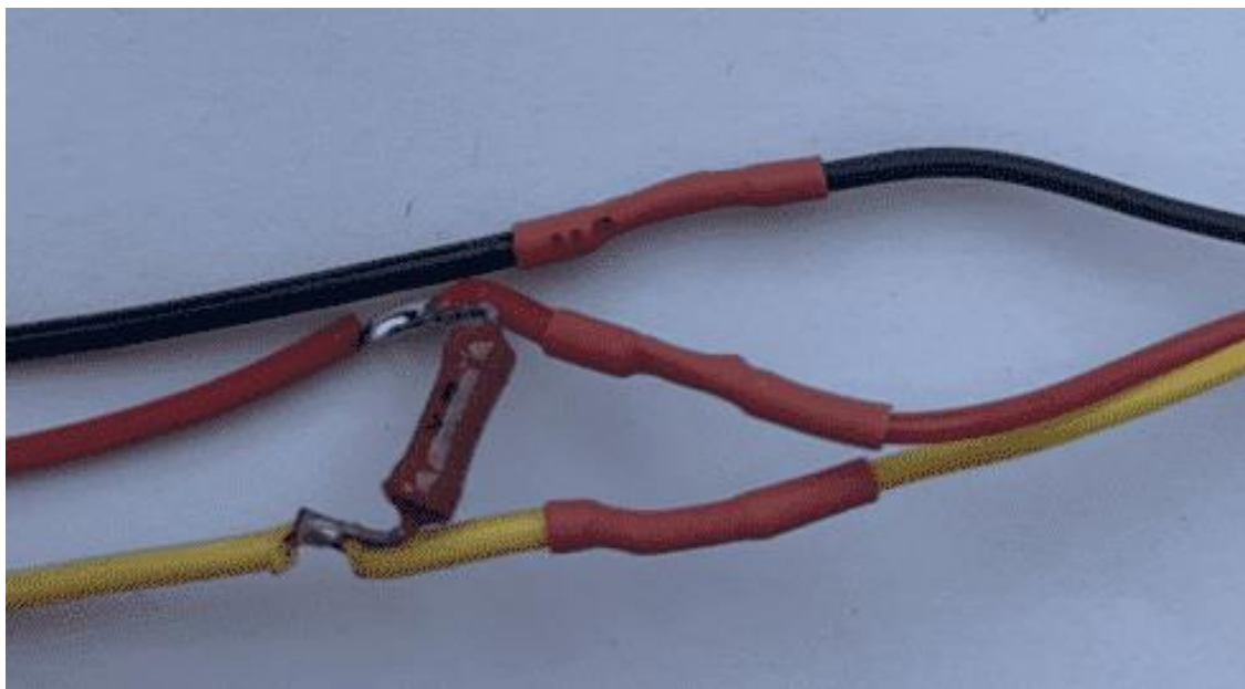
Рис. 4.14. Результат впаювання резистора
