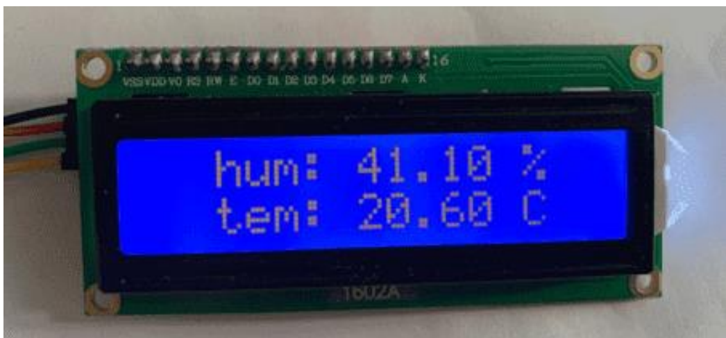
Рис. 4.9. Результат роботи датчика DHT22
