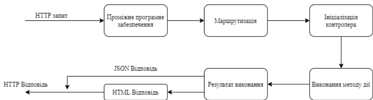
Рис. 2.2. Життєвий цикл HTTP запиту в ASP.NET Core
