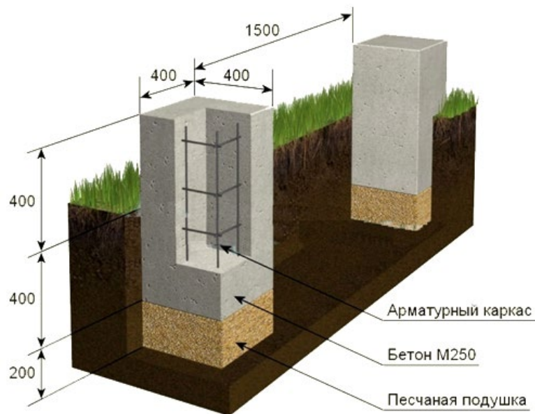
Рис. 2.4. Наглядне зображення монолітного стовпчастого фундаменту
