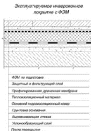
Рис. 2.9. Схема шарів покрівлі
