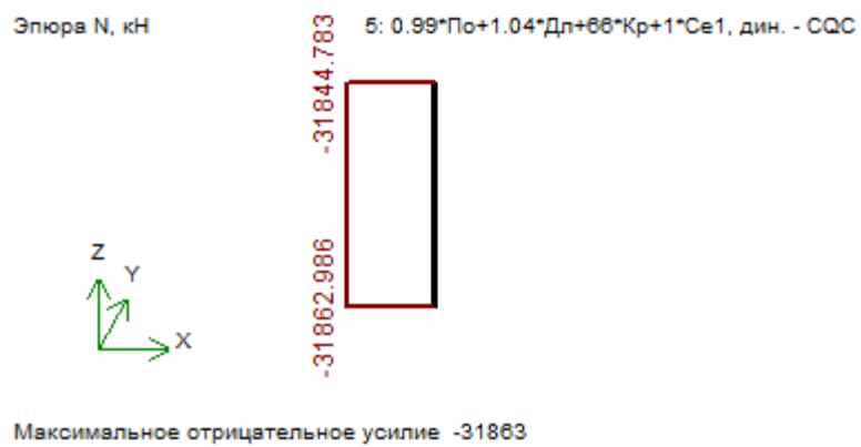
Рис 3.18. Епюра повздовжніх зусиль N в колоні 1_1 першого поверху по четвертому сполученню зусиль
