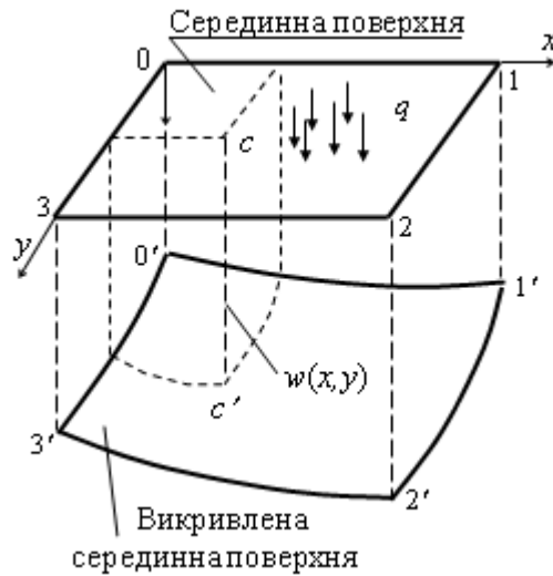
Рис. 1.5. Згинання тонкої пластини
