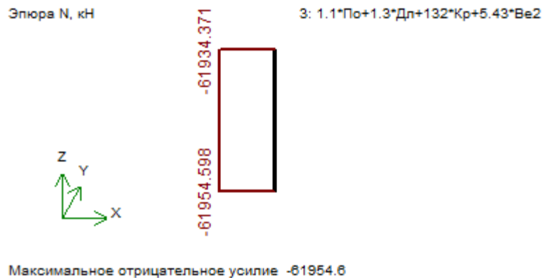
Рис 3.17. Епюра повздовжніх зусиль N в колоні 1_1 першого поверху по третьому сполученню зусиль
