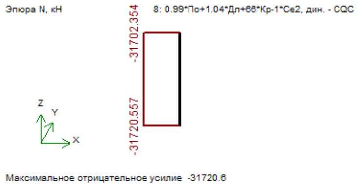
Рис 3.21. Епюра повздовжніх зусиль N в колоні 1_1 першого поверху по сьомому сполученню зусиль
