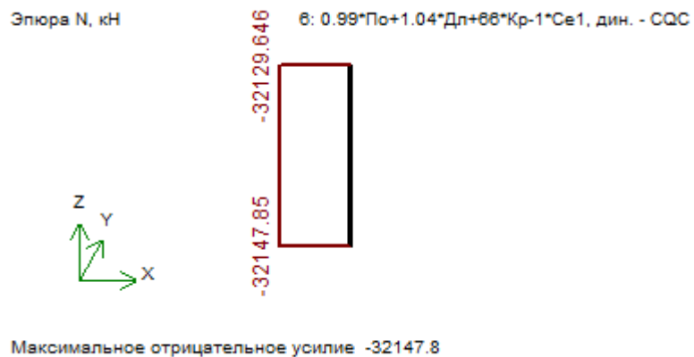
Рис 3.20. Епюра повздовжніх зусиль N в колоні 1_1 першого поверху по шостому сполученню зусиль
