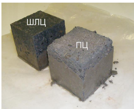
Рис. 2.12. Поверхня зразків бетонів після випробувань на морозостійкість: ПЦ – бетон на основі портландцементу М400; ШЛЦ – бетон на основі пластифікованого шлаколузного цементу
