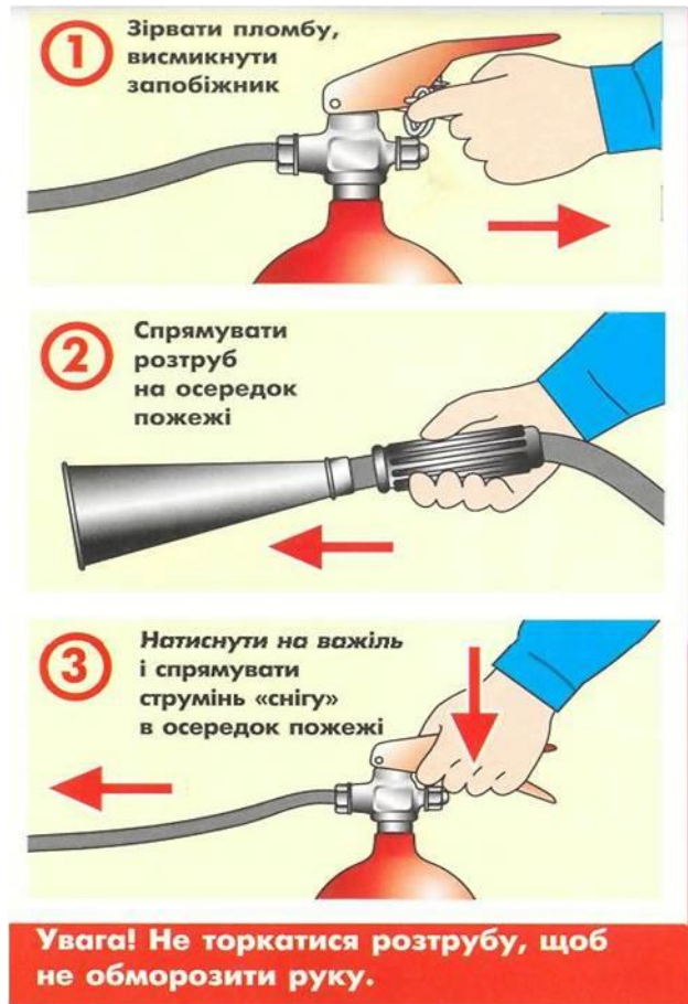
Рис. 8.2 Порядок приведення у дію вуглекислотного вогнегасника
