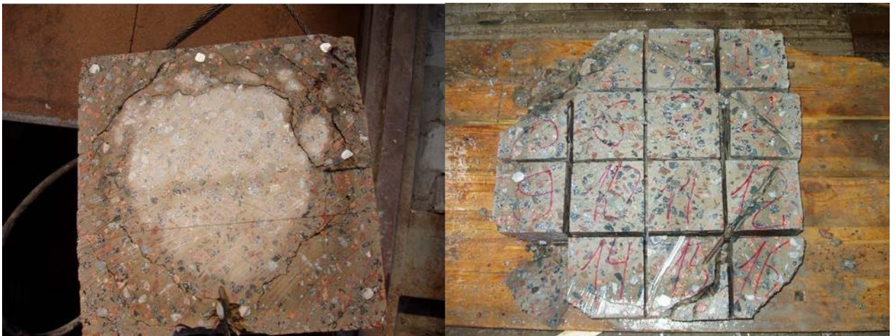
Рисунок 3.5 – Перетин колони після розрізання та нумерація зразків-кубів
