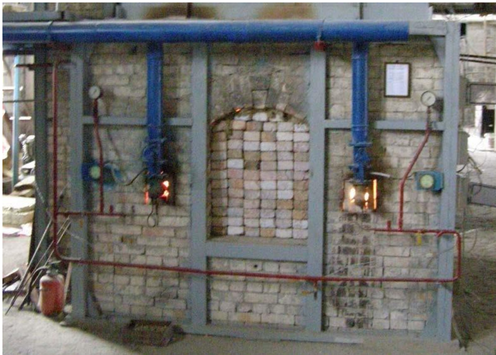
Рисунок 3.2 – Вигляд печі під час випробування колони
