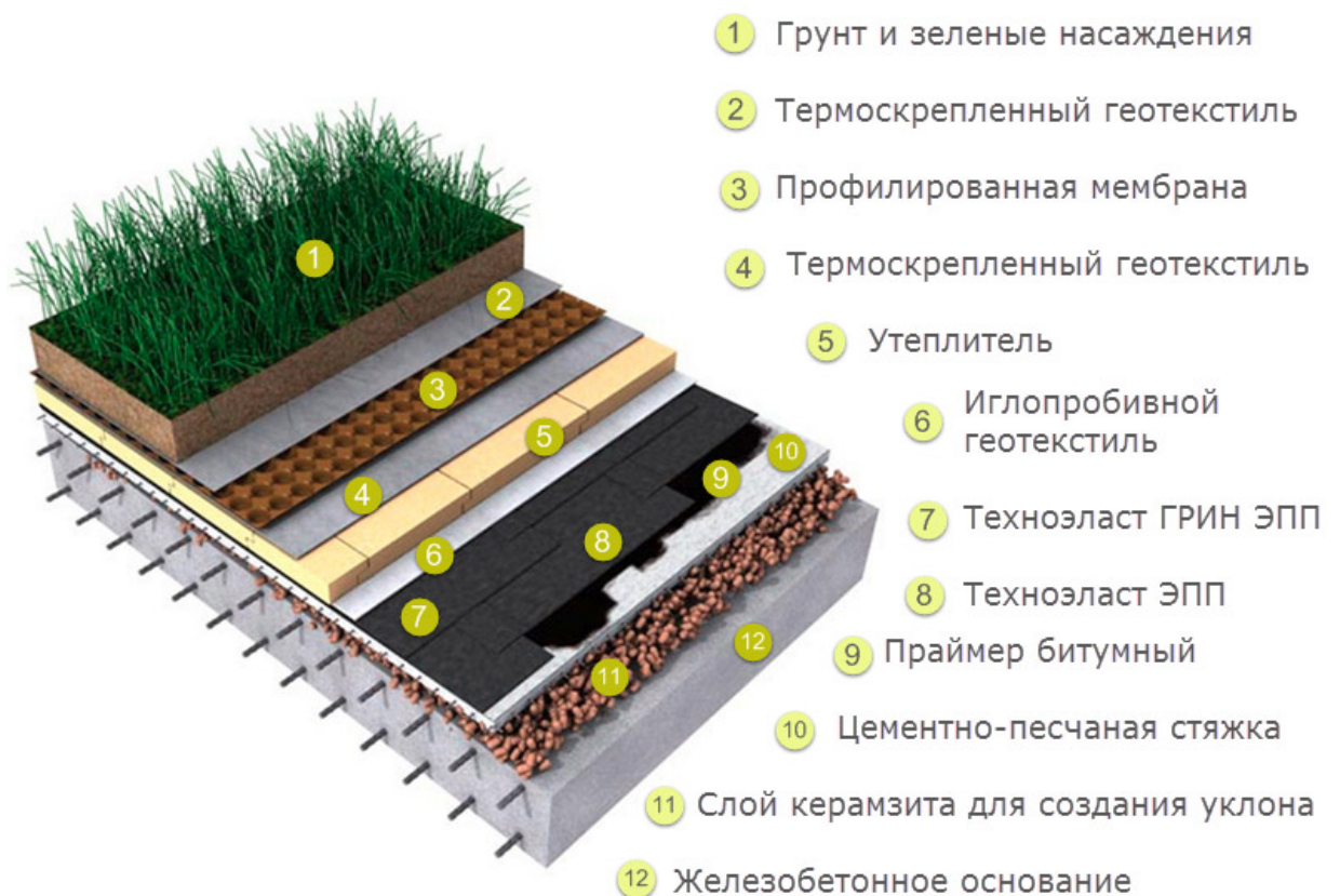
Рис. 2.10. Шари покрівлі із газоном
