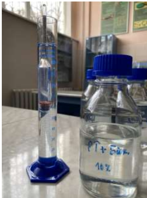
Рис.3.7 Визначення густини палива РТ з додавання біокомпоненту 10%
