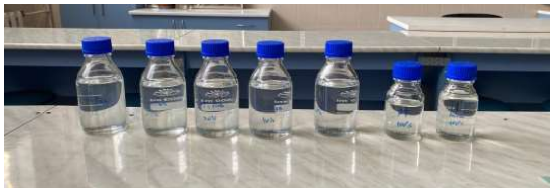
Рис. 3.3 проби палива з різним відсотковим вмістом біокомпоненту
