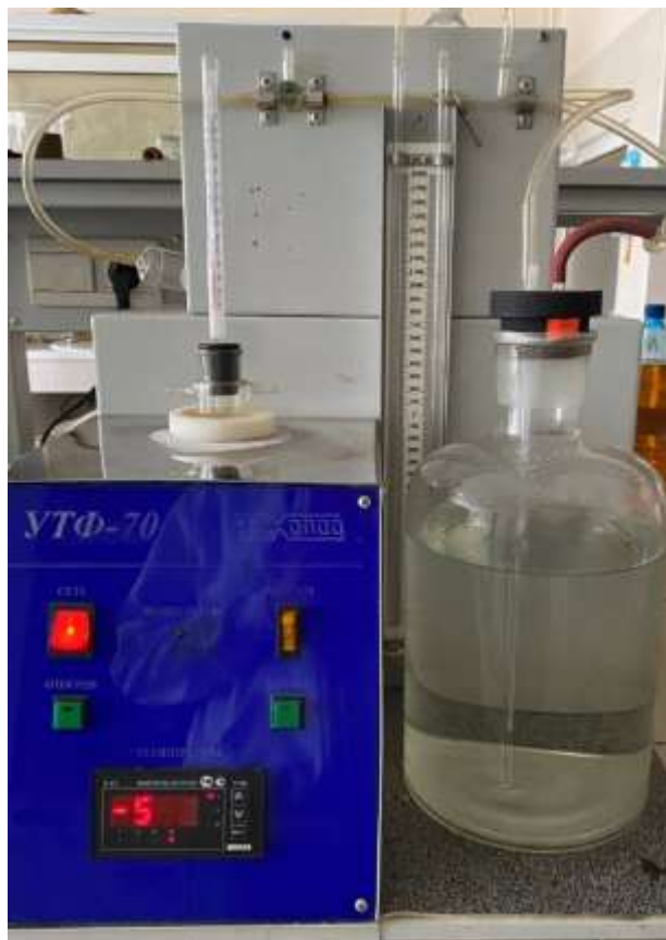
Рис.3.12 Визначення температури кристалізації на приладі УТФ-70
