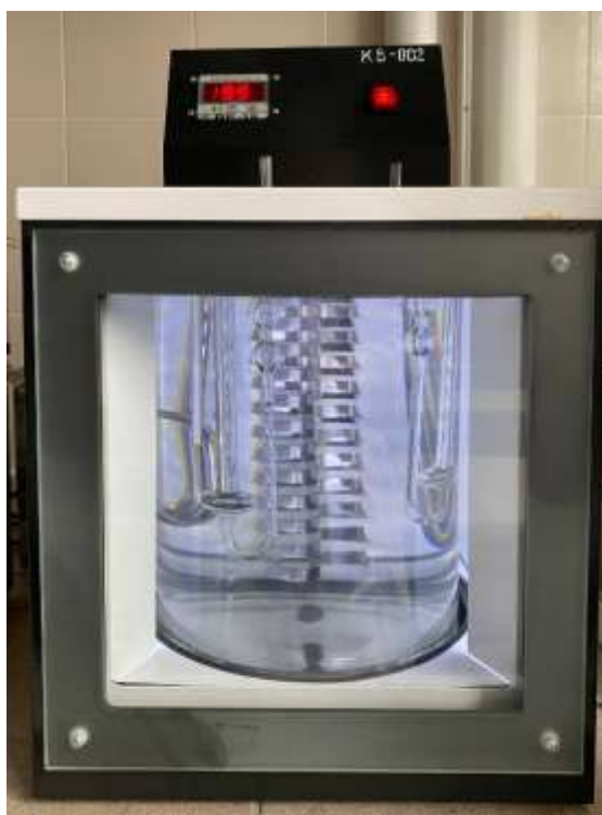
Рис.3.10 Визначення в'язкості апаратом KV-002
