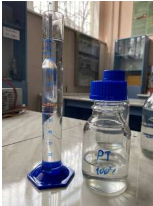
Рис. 3.6 Визначення густини палива РТ
