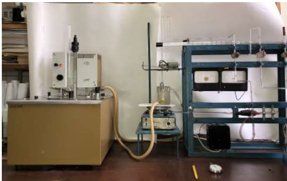
Рисунок 3.2. Газометрична установка для окиснення органічних сполук в ІБОНХ
