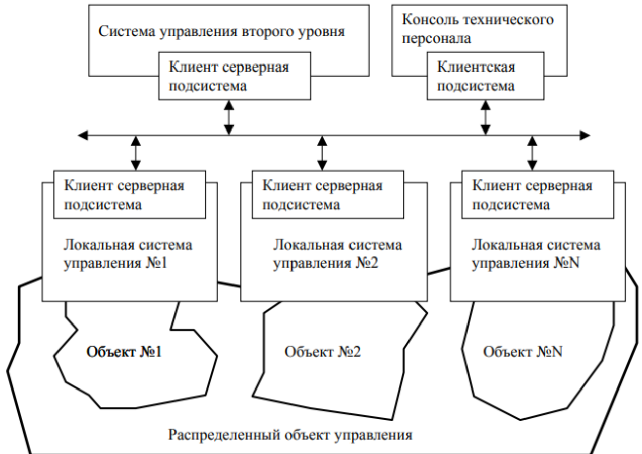
Рис. 1.1. Клієнт – серверна архітектура для систем управління.
