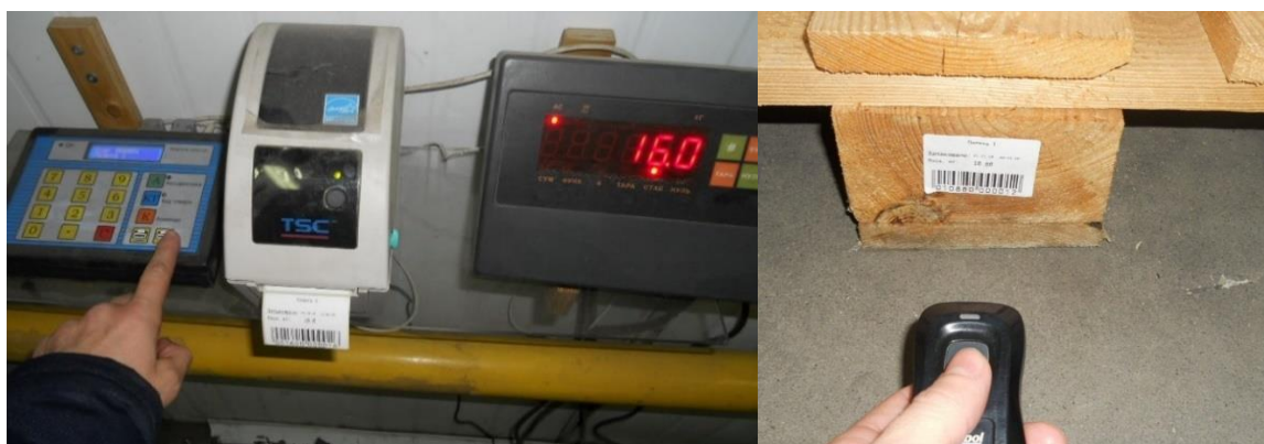
Рисунок 3.4 – Приклад наклеювання етикетки на піддон
