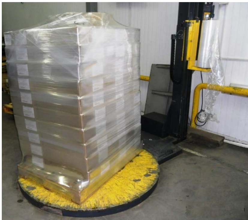
Рисунок 3.6 – Приклад стрейчування піддону із замовленням
