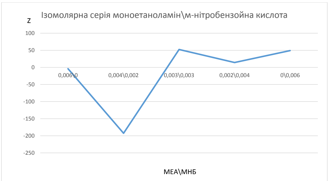
Рис. 3.4. Графік залежності ступеню захисту при корозії сталі від співвідношення концентрацій моноетаноламіну та м-нітробензойної кислоти, за їх загальної концентрації 0,01 моль/дм 3 .
