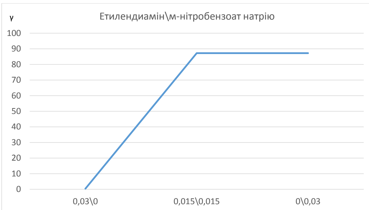
Рис. 3.8. Графік залежності коефіцієнту гальмування корозії сталі від співвідношення концентрацій етилендіаміну та м-нітробензоату натрію, за їх загальної концентрації 0,03 моль/дм 3 .
