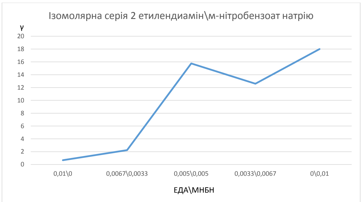
Рис. 3.6. Графік залежності коефіцієнту гальмування корозії сталі від співвідношення концентрацій етилендіаміну та м-нітробензоату натрію, за їх загальної концентрації 0,01 моль/дм 3 .
