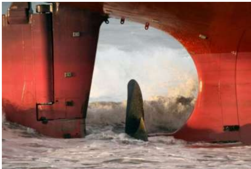
Рис.1.17. Розміщення протекторів на корпусі корабля
