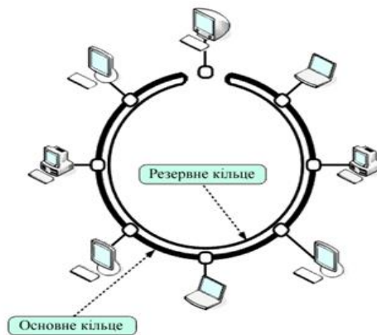
Рис. 1.3. Реконфігурація кілець FDDI при відмові
