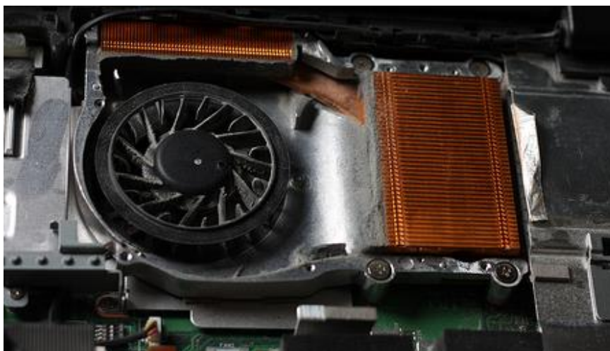
Рис. 1.9. Забруднена система охолодження ноутбука
