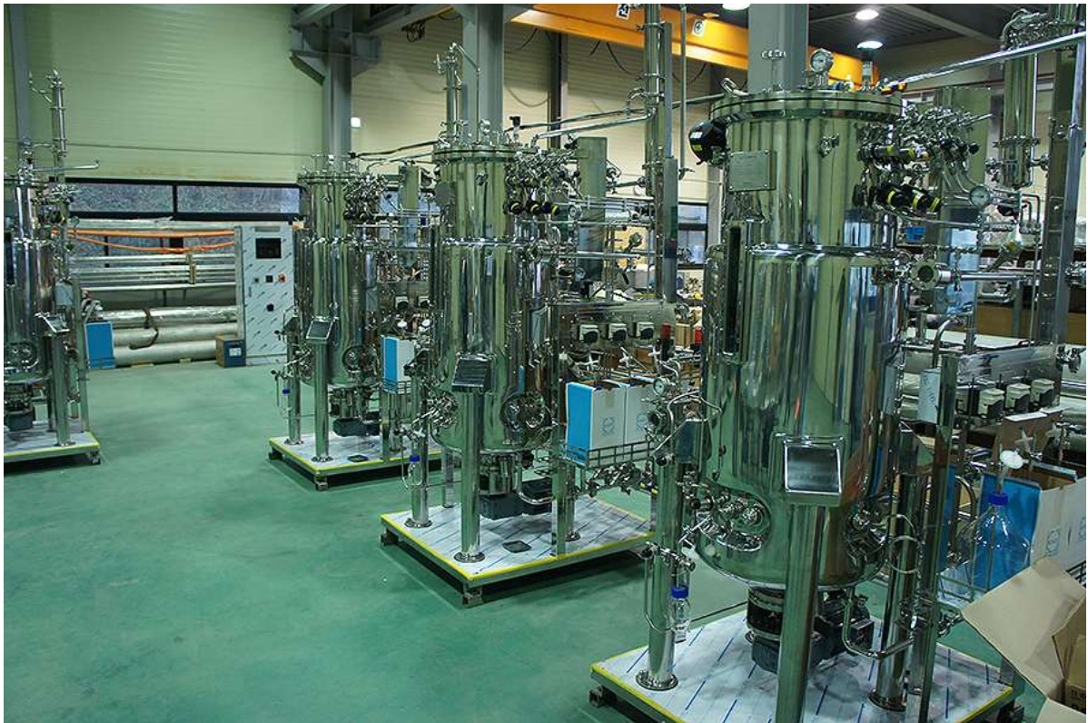
Рис. 3.10. Промисловий ферментер BIORUS 300L
