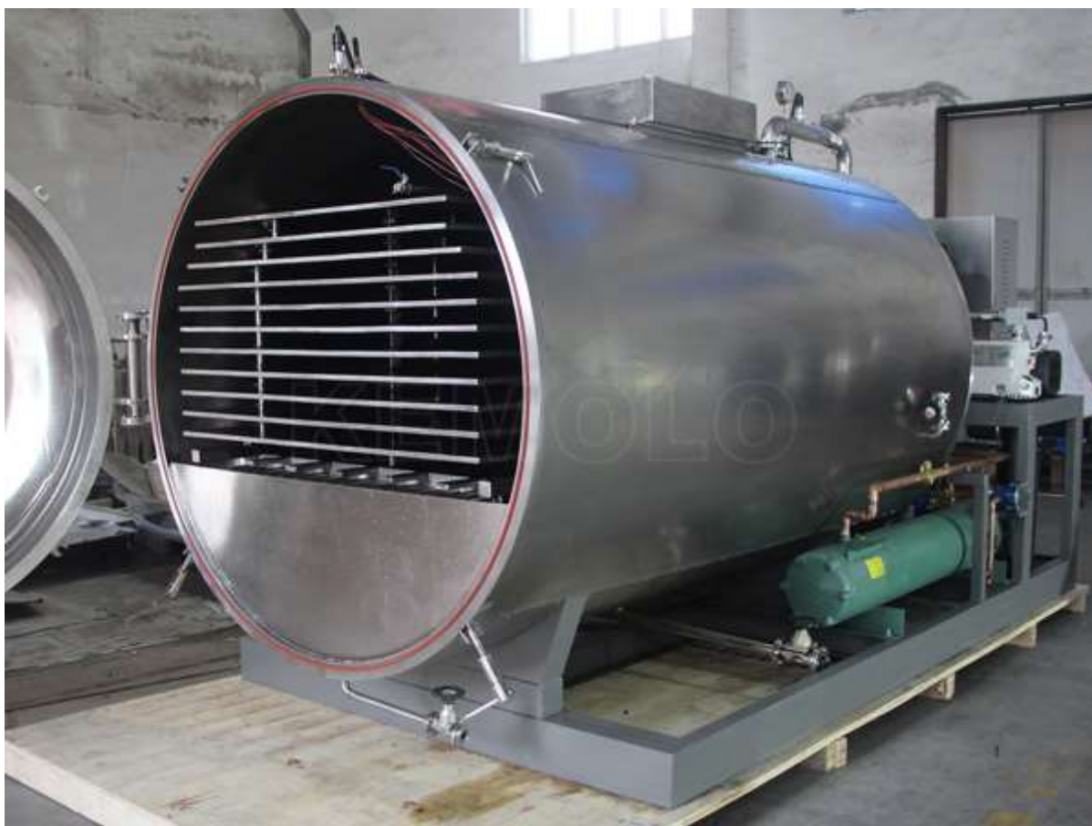
Рис. 3.11. Ліофілізатор KEMOLO FD300 [66]
