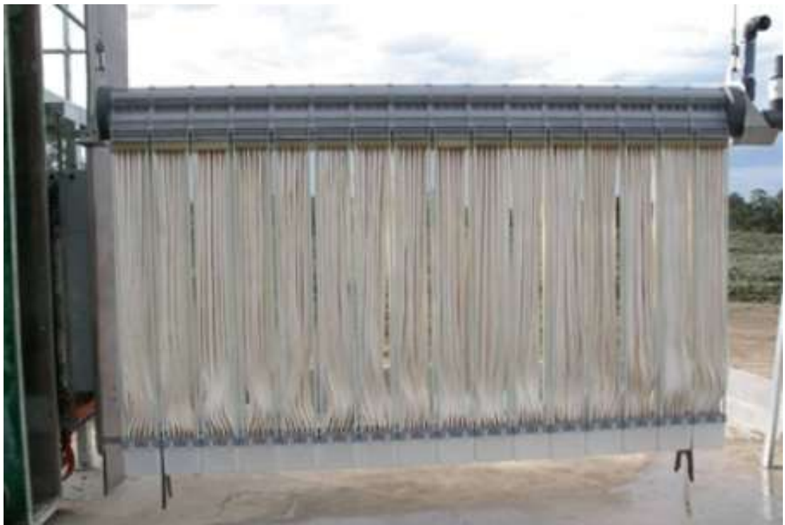
Рис. 3.2. Поволоконний мембранний модуль компанії Siemens
