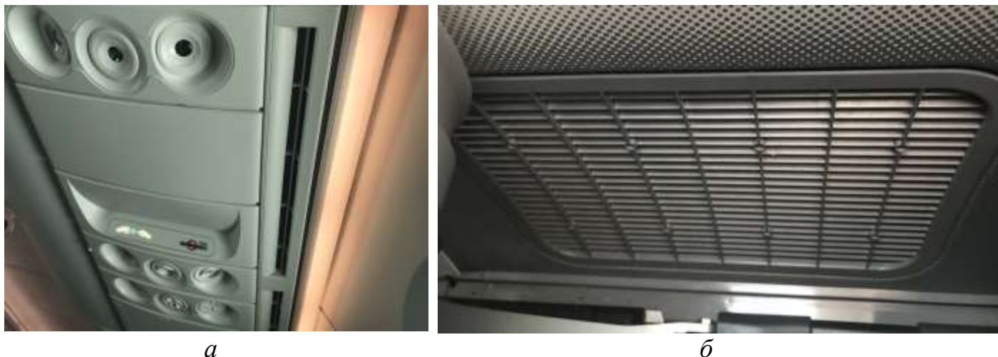
Рис. 2.2. Елементи подачі (а) та відбору (б) повітря в салоні літака
