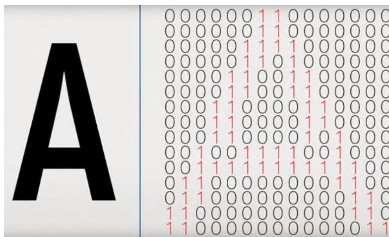
Рис. 1.3. Зразок представлення символу у вигляді двійкової матриці
