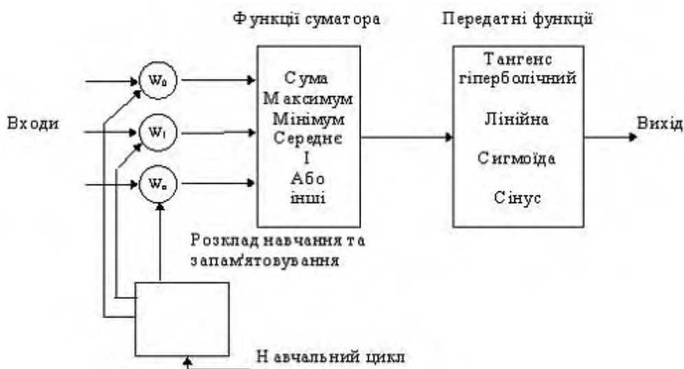
Рис. 2.4. Модель «елементу обробки»
