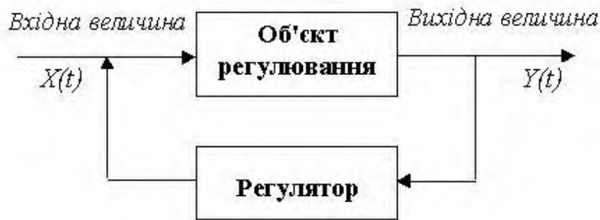
Рис. 1.1. Структурна схема прямого автоматичного регулювання
