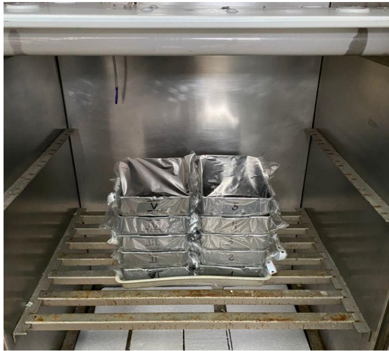
Рис. 3.2. Розміщення проб у термостат з температурою 24 °С
