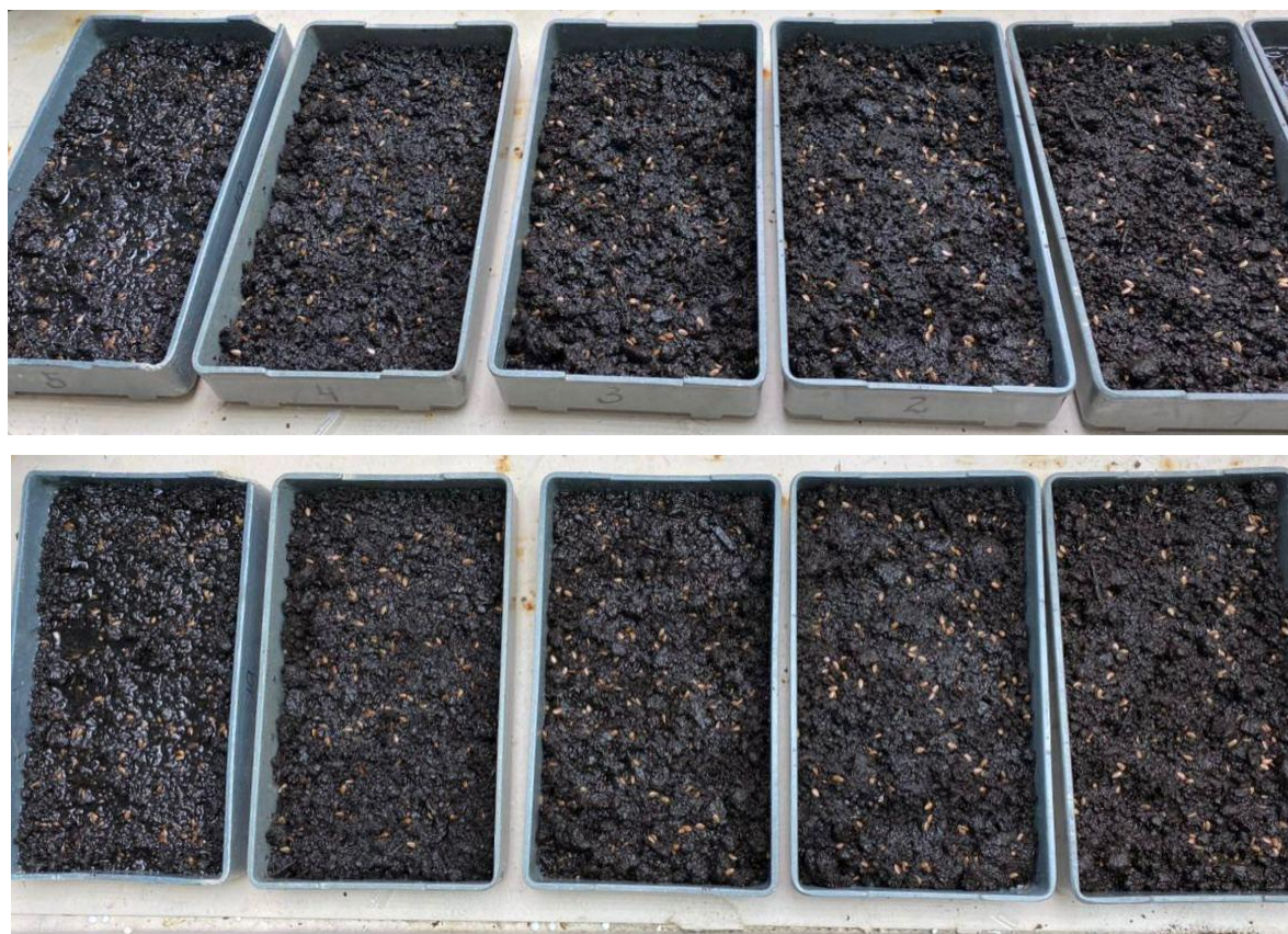
Рис. 3.1. Проби ґрунту штучно забруднені нафтопродуктом
