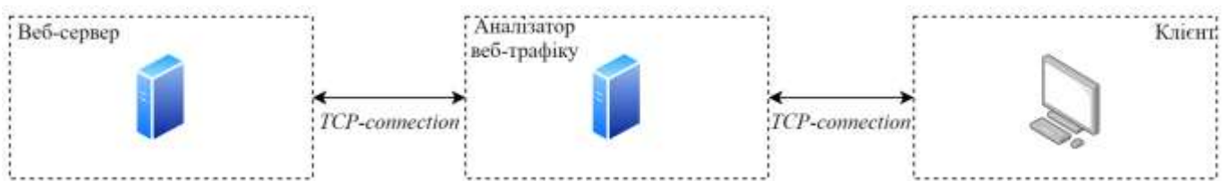
Рис.3.4. Система керування доступом до розподілених веб-ресурсів з точки зору MITM
