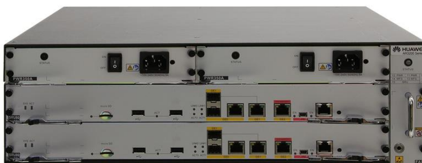
Рис.3.5. Маршрутизатор Huawei AR-3200-SRU200
