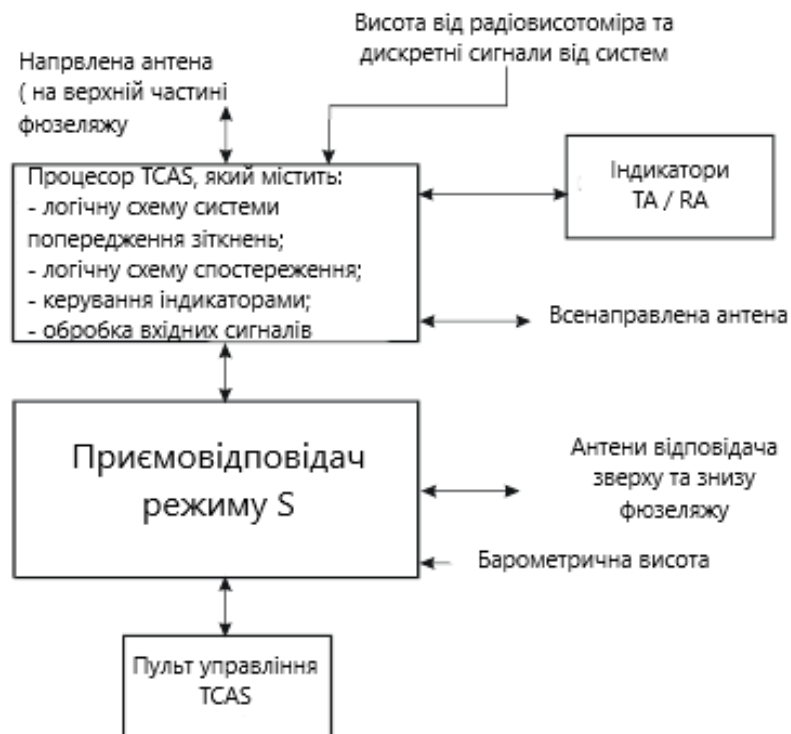
Рисунок 1.4 Структурна схема TCAS II
