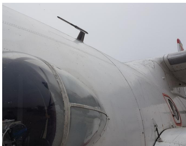
Рис. 1.17. Встановлення приймача ПВД-7 по лівому борту
