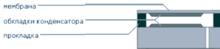
Рис.2.12. Ємнісний керамічний перетворювач тиску, виконаний методами мікромеханіки.
