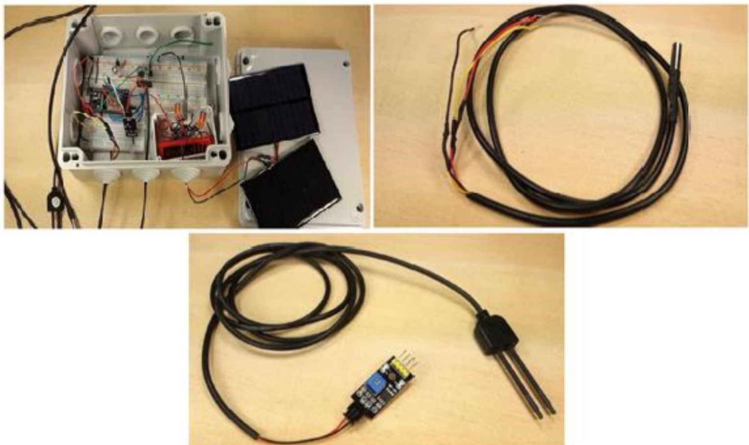
Рис. 3.4. LoRa передавач, датчик температури та датчик вологості ґрунту (зліва направо, відповідно)
