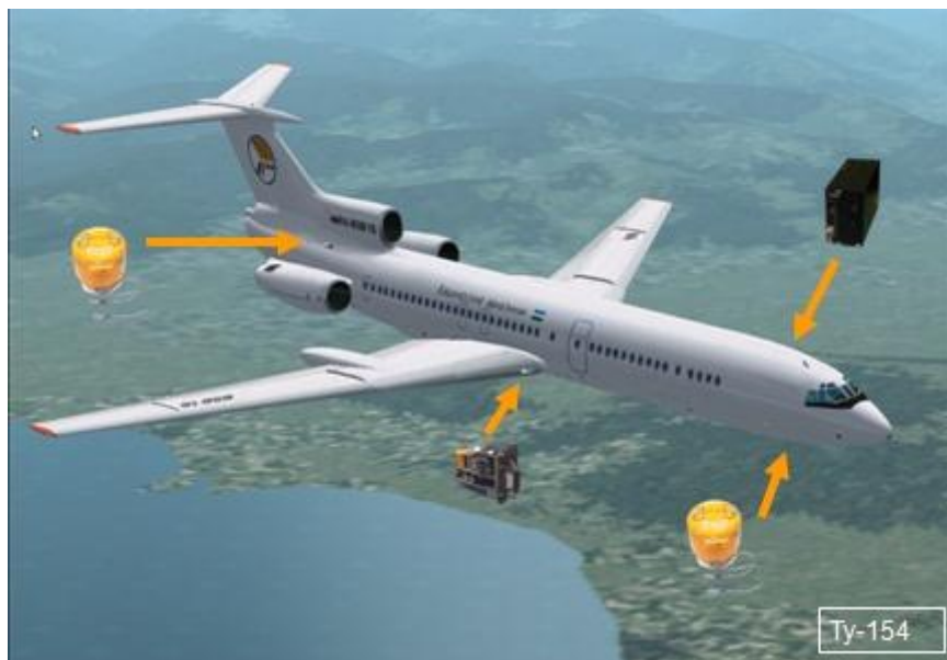
Рис. 2.3 Розміщення бортових накопичувачів на літаку.
