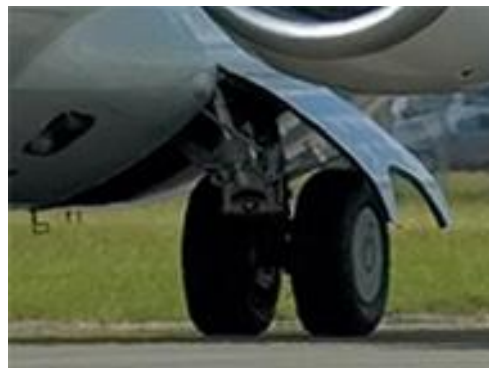
Рис. 1.4. Основна опора шасі
