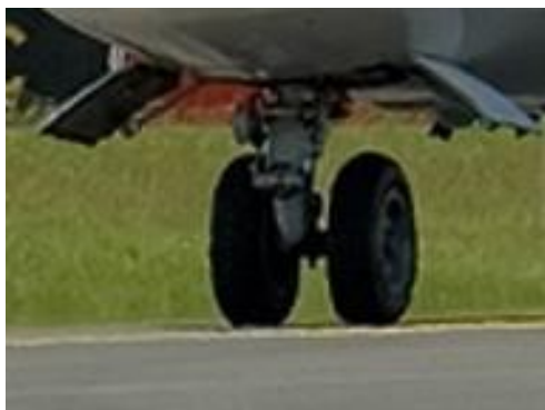
Рис. 1.3. Передня опора шасі
