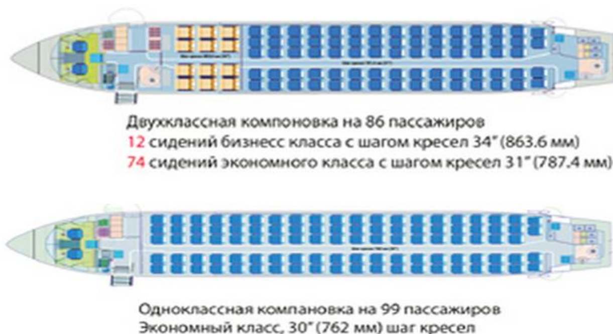
Рис.1.2. Компоновка салону літака Ан-158
