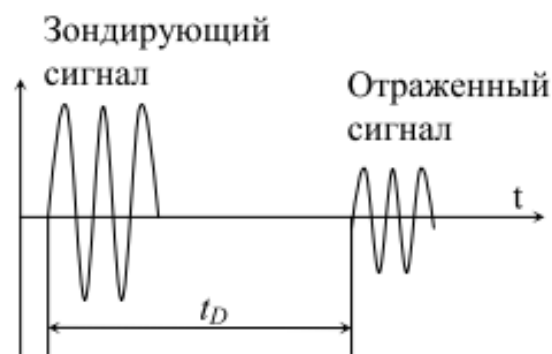
Рис. 3.16. Епюри напруг імпульсного методу вимірювання дальності
