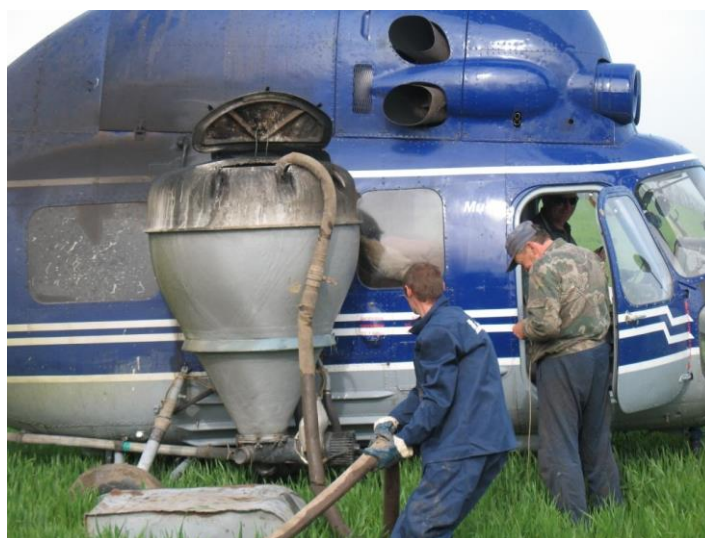
Рис. 2.7. Заправка баків для хімікатів вертольоту Мі-2
