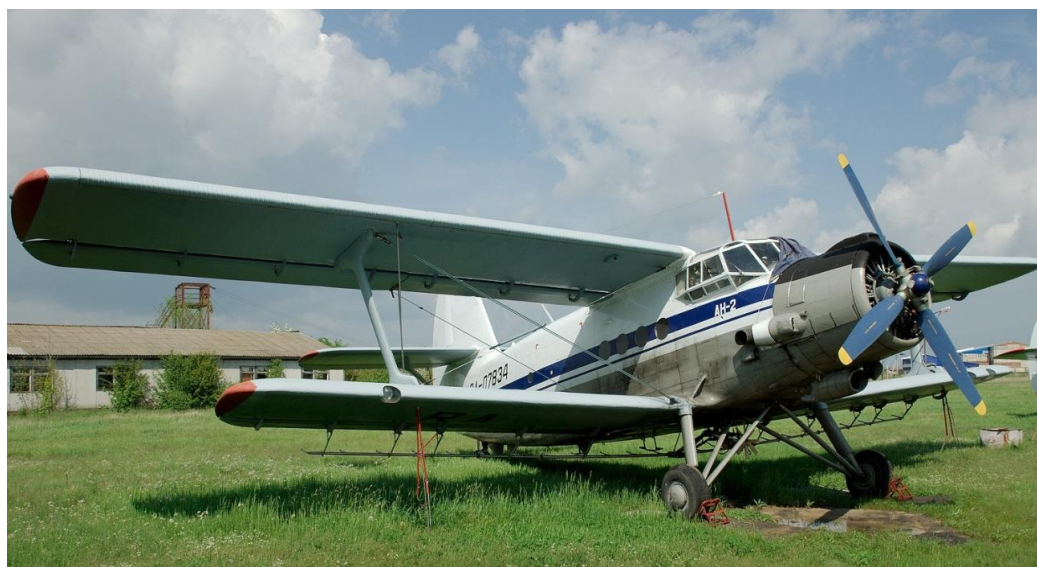
Рис. 2.2. АН-2СХ з підкрильними штангами для рідких хімікатів
