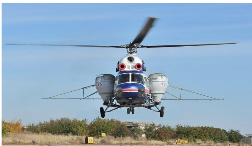
Рис. 2.6. Мі-2 із підвісними баками для хімікатів та штангою для обприскування
