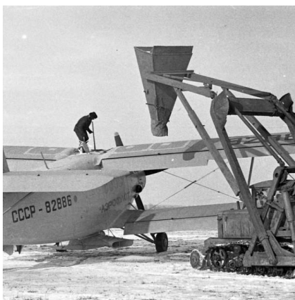
Рис. 2.3. Заправка хімікатами АН-2СХ з тунельним розпилювачем для сипучих речовин
