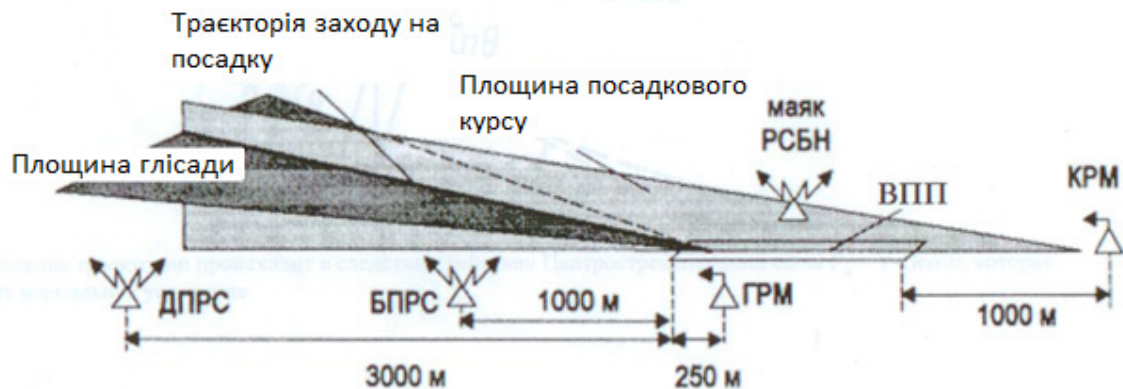
Рисунок 1.2. Розміщення радіомаяків щодо ЗПС і принцип формування траєкторії посадки
