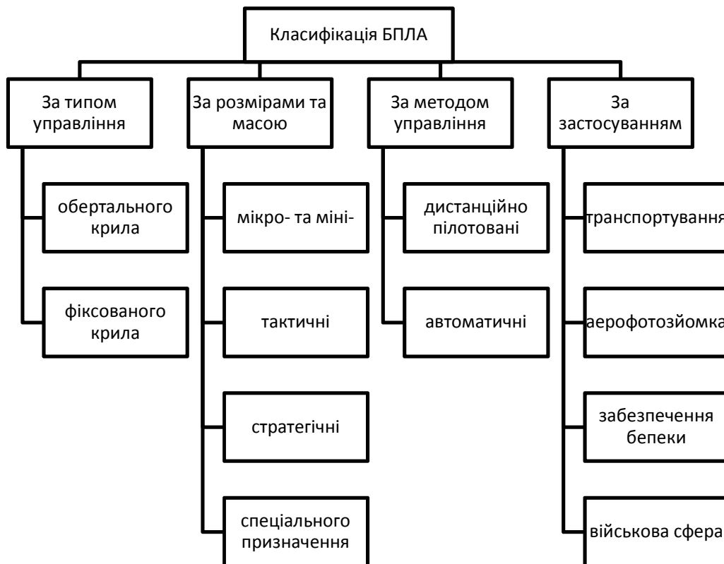
Рис.1.2. Класифікація безпілотних літальних апаратів.
