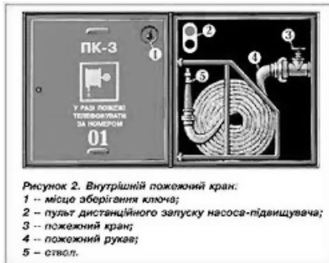
Рис. 4.24. Внутрішній пожежний кран
