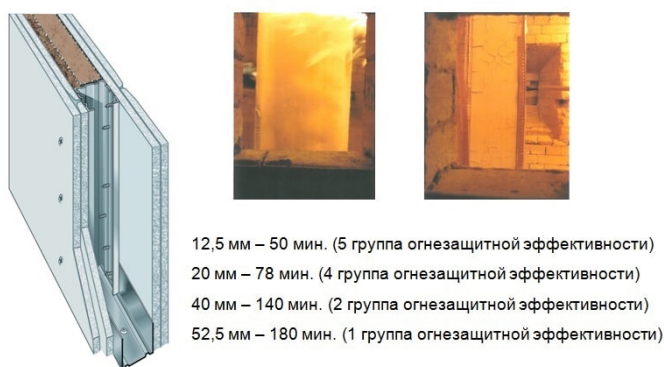
Рис.4.18. Склад вогнестійкого гіпсокартону
