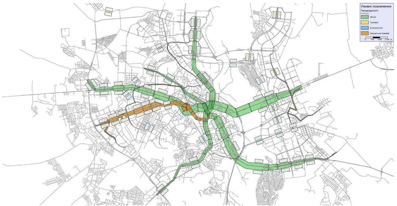
Рисунок 3.11 - Картограма пасажиропотоків швидкісного рейкового пасажирського транспорту при поверненні лінії швидкісного трамваю в центр (за даними [94])
