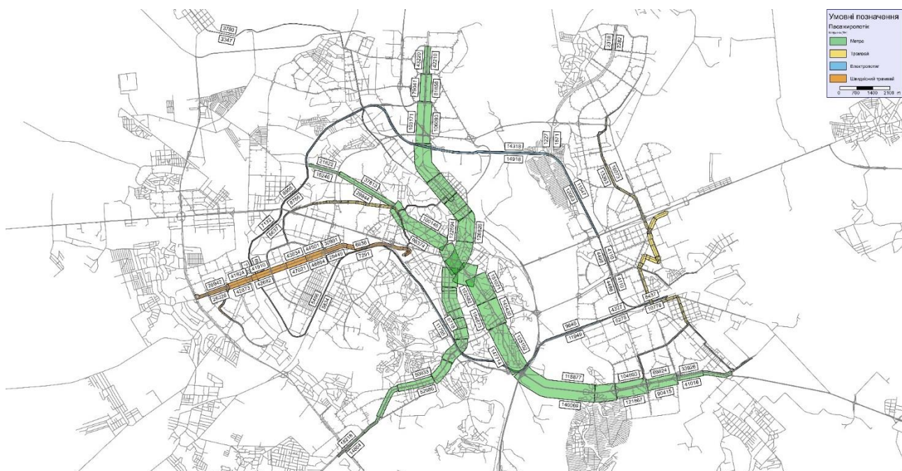
Рисунок 3.10 - Картограма пасажиропотоків швидкісного рейкового пасажирського транспорту при відсутності червоної лінії в транспортній системі (за даними [94])
