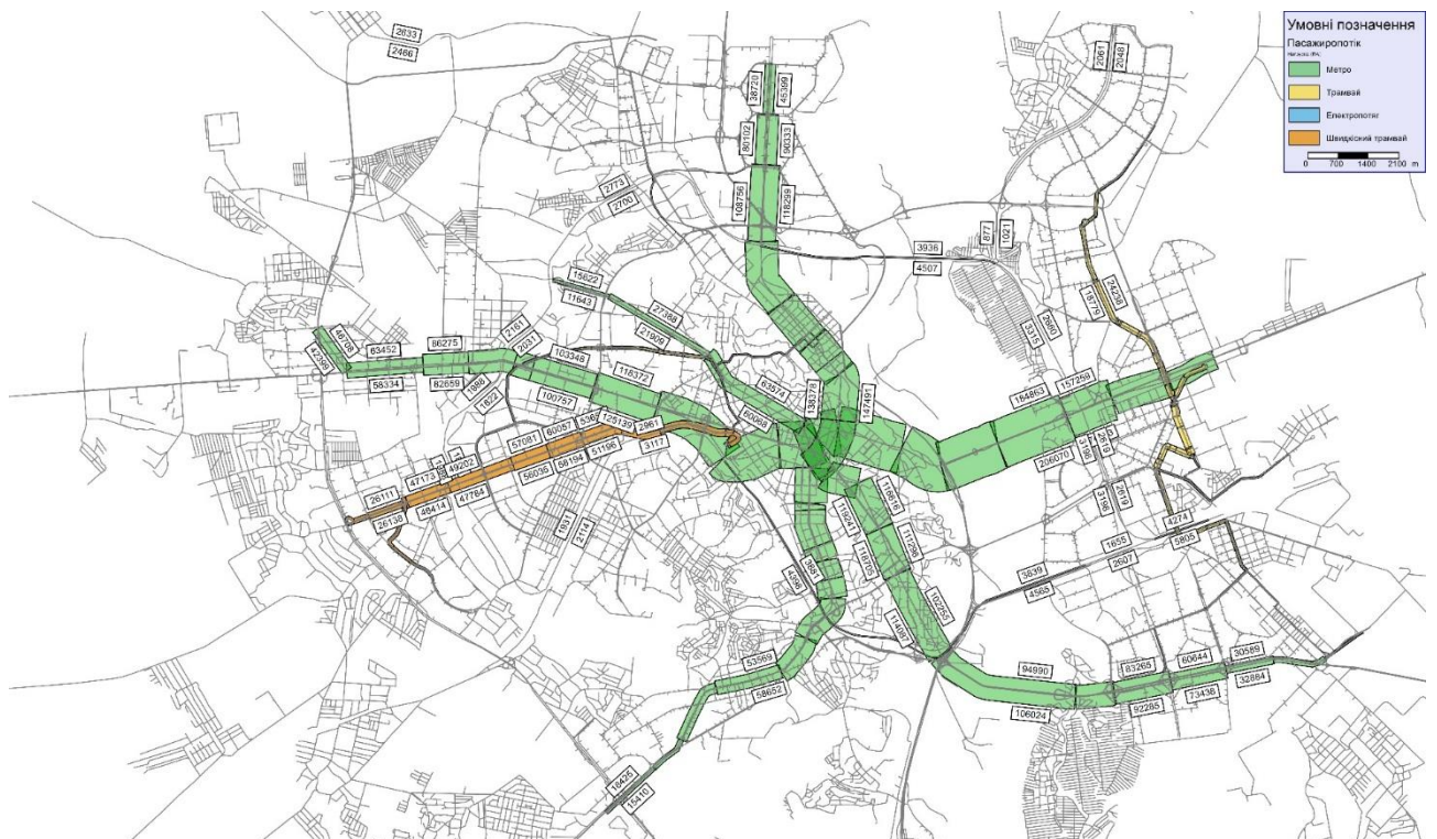
Рисунок 3.5 - Картограма пасажиропотоків рейкового пасажирського транспорту, поточний стан (за даними [94])
