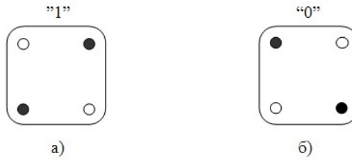
Рис.1.8 – Діагональне розміщення електронів на квантових точках в КА, які відповідають логічній одиниці (а) та нулю (б)
