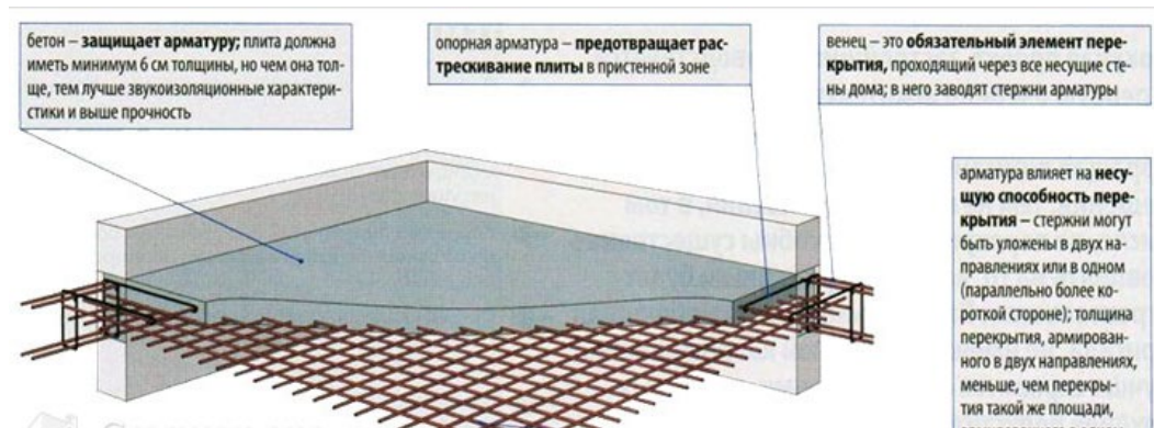
Рис. 5.8. Схема влаштування монолітного перекриття
