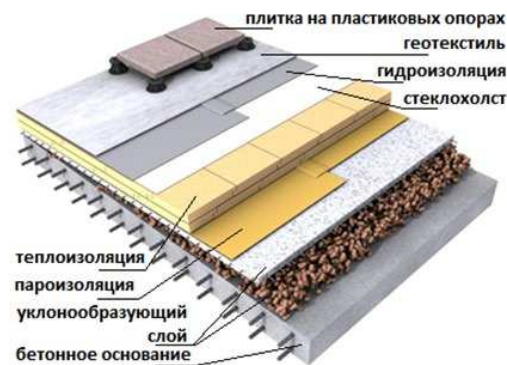
Рис. 5.14. Схема влаштування плоскої експлуатованої покрівлі
