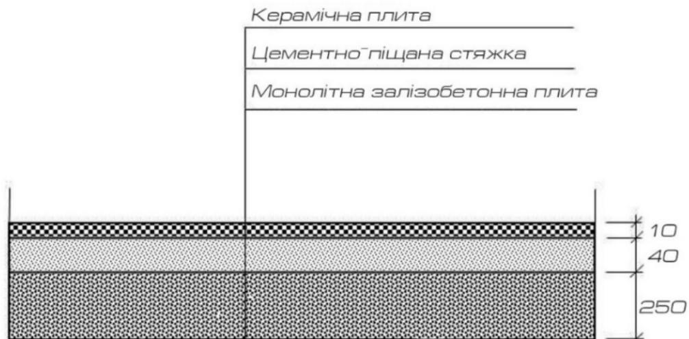
Рис. 5.9. Схема монолітного залізобетонного перекриття
