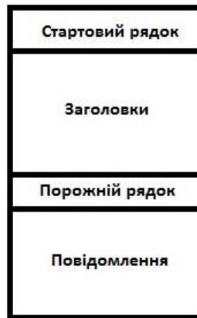
Рис.2.8 «Структура повідомлень протоколу SIP»
