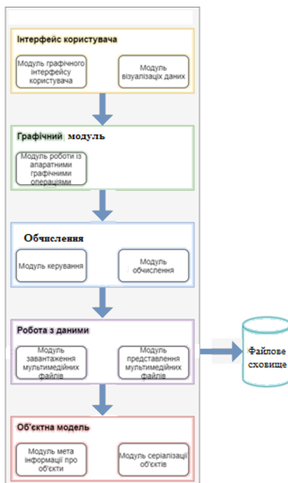
Рис. 3.2. Структурна схема архітектури ПЗ для тренування на тренажері
