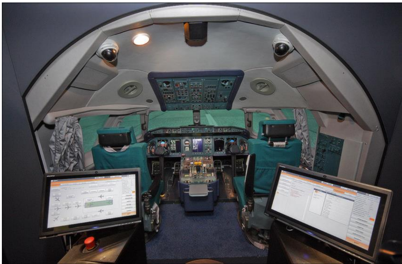
Рис. 2.2. Імітатор кабіни літака АН-140
