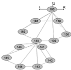
Рис. 3. Багатоярусна радіально-кільцева топологія глобальної мережі
