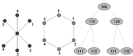
Рис. 1. Топологія локальних мереж: радіальна, кільцева і зовнішня мережі
