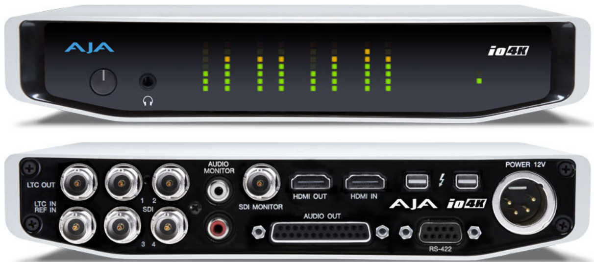
Рис. 2.11. Карта розширення AJA Io® 4K Powerful Mobile Thunderbolt I/O
