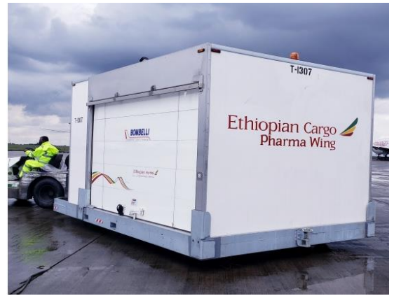
Рис. 3.8. Авіаційний рефрижераторний контейнер «BOMBELLI Arctic Cool Dolly» для перевезення швидкопсувної продукції, фармацевтичної, включаючи вакцини COVID-19
