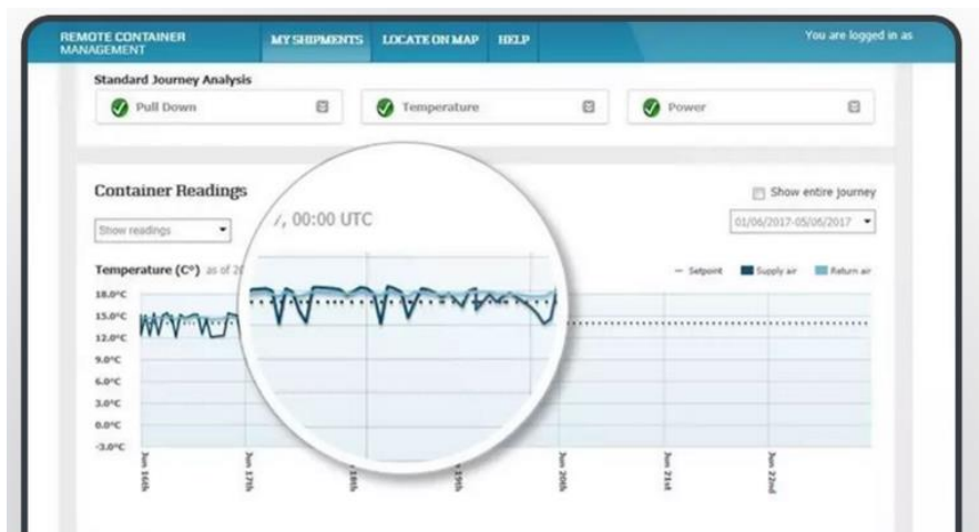
Рис. 3.12. Інтерфейс системи віддаленого управління контейнерами (контроль температурного режиму)
