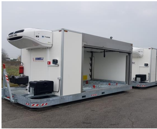
Рис. 3.8. Авіаційний рефрижераторний контейнер «BOMBELLI Arctic Cool Dolly» для перевезення швидкопсувної продукції, фармацевтичної, включаючи вакцини COVID-19
