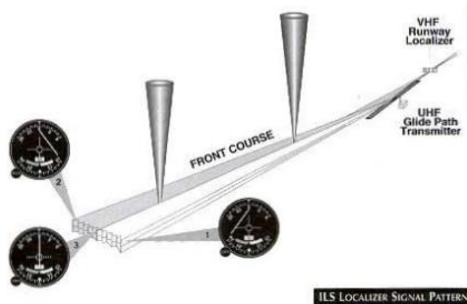
Мал. 1.3 Схема сигналу локалізатора
